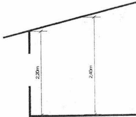
Figura 1 - Altura mínima do teto inclinado
