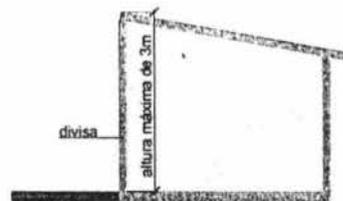
Figura 21 - Altura máxima da edícula colada nas divisas do terreno
