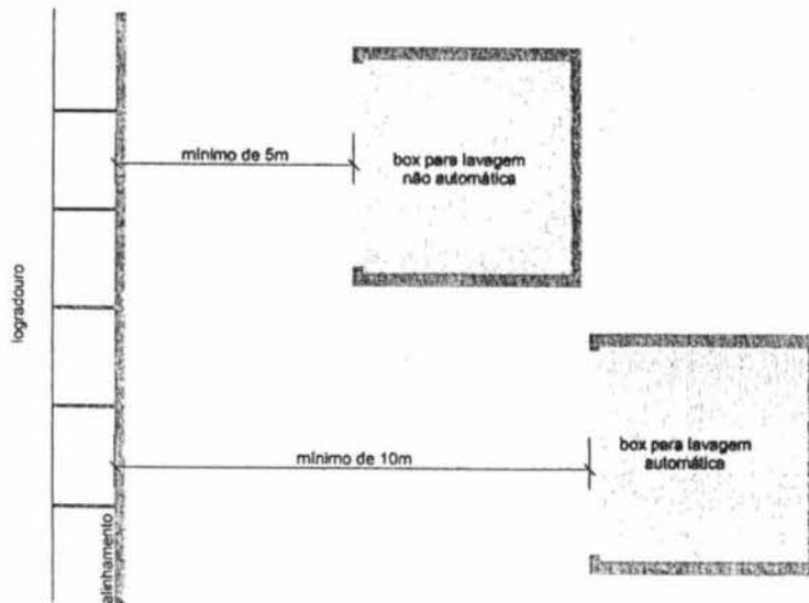
Figura 28 - Distâncias mínimas do box para lavagem de veículo paralelo ao logradouro
