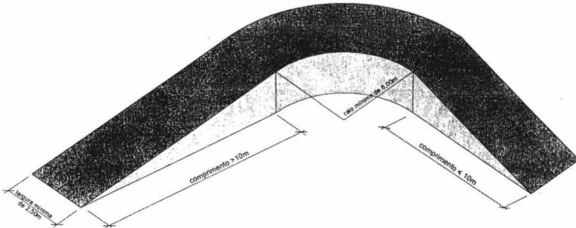
Figura 16 - Dimensionamento das rampas de garagens e estacionamentos
